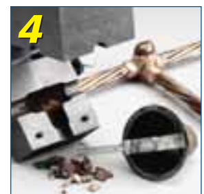
4 Ouvrez le moule et enlevez la coupelle en acier – pas d'élimination spéciale exigée
